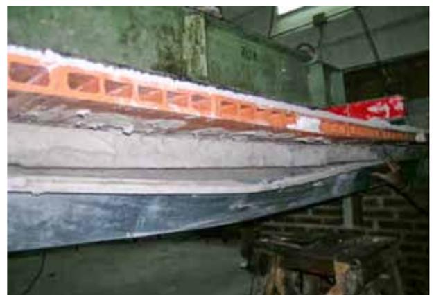
La viga de muestra en el momento del colapso
