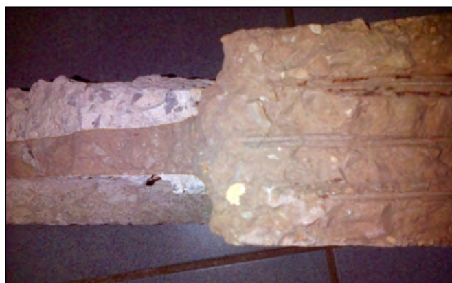
Foto bigueta amb dos formigons: la bigueta està fabricada amb ciment aluminós i les restes de formigó enganxats al lateral són de ciment portland.
